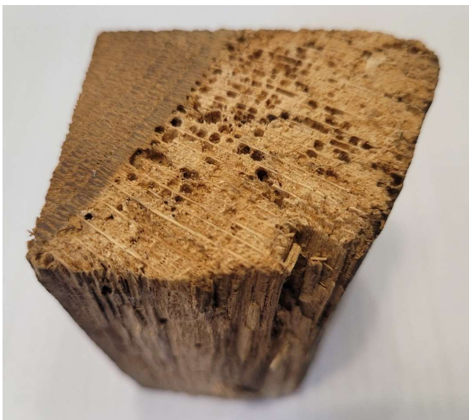
Figuur 25 Eiken, met perfect kernhout en volledig aangetast spint
