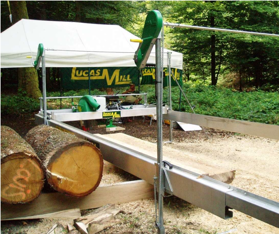
Figuur 34 Mobile cirkelzaag, door het kantelen van de zaag over 90° kan men planken in hoek uitzagen (juist nog zichtbaar op de foto)
