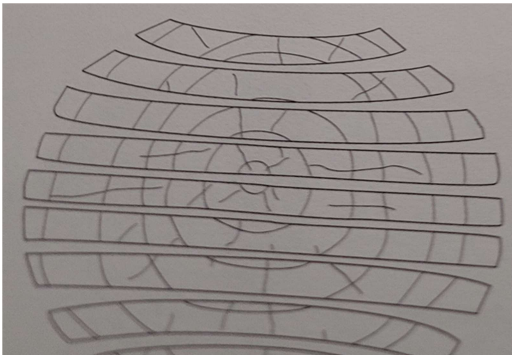
Figuur 32: Krimp van boolplanken na droging
