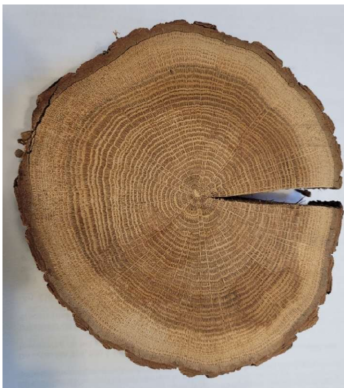
Figuur 28 Zomereik met duidelijke spintlaag, radiale barst ten gevolge van tangentiale krimp
