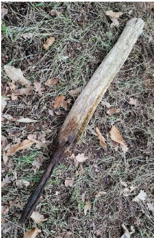
Figuur 24 Eiken weidepaal met volledig weggerot spint (maar nog intact kernhout)
