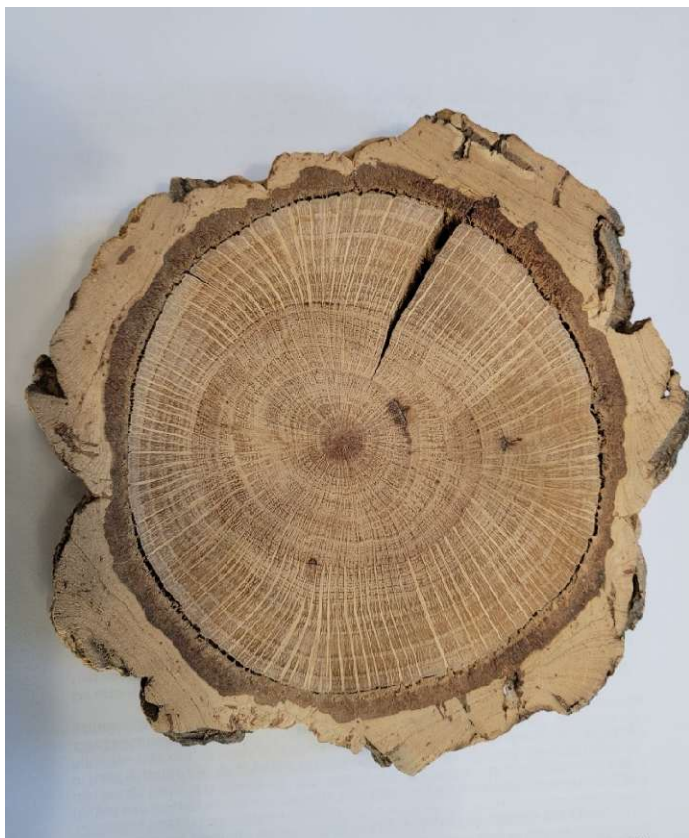
Figuur 27 Kurkeik, radiale barst ten gevolge van tangentiale krimp
