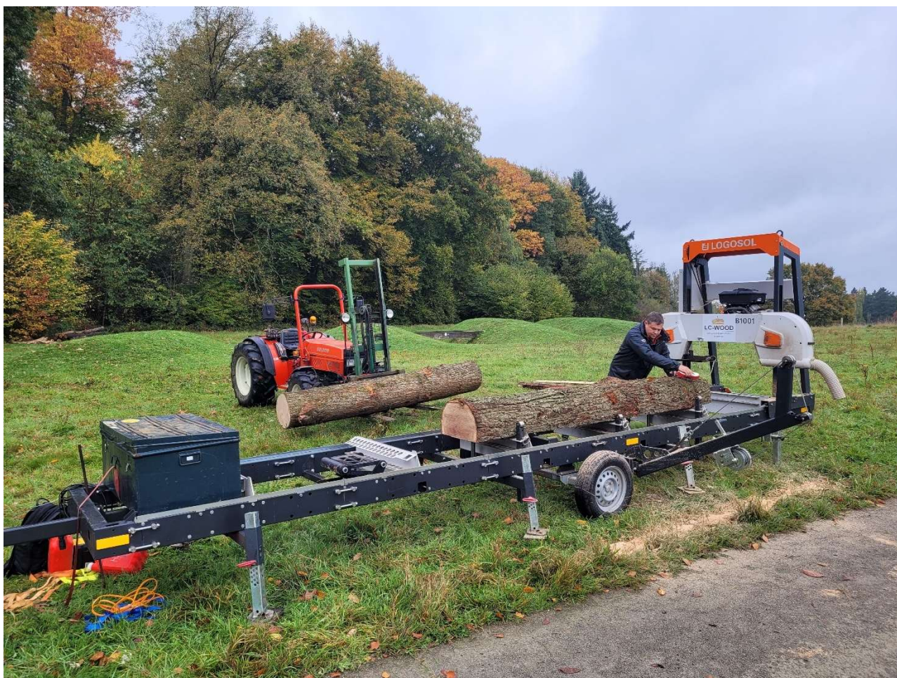
Figuur 13 Mobile zaag met manuele belading
